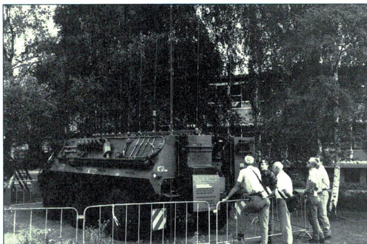
De verbindingdienst (zie RAM 131) van de Koninklijke Landmacht heeft o.a. de beschikking over deze omgebouwde YP-pantserwagen, waarmee verbindingen kunnen worden gemaakt en gestoord.
